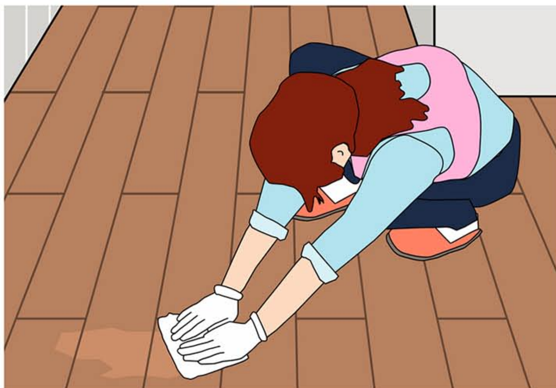
塗装面にすり込むように塗る
